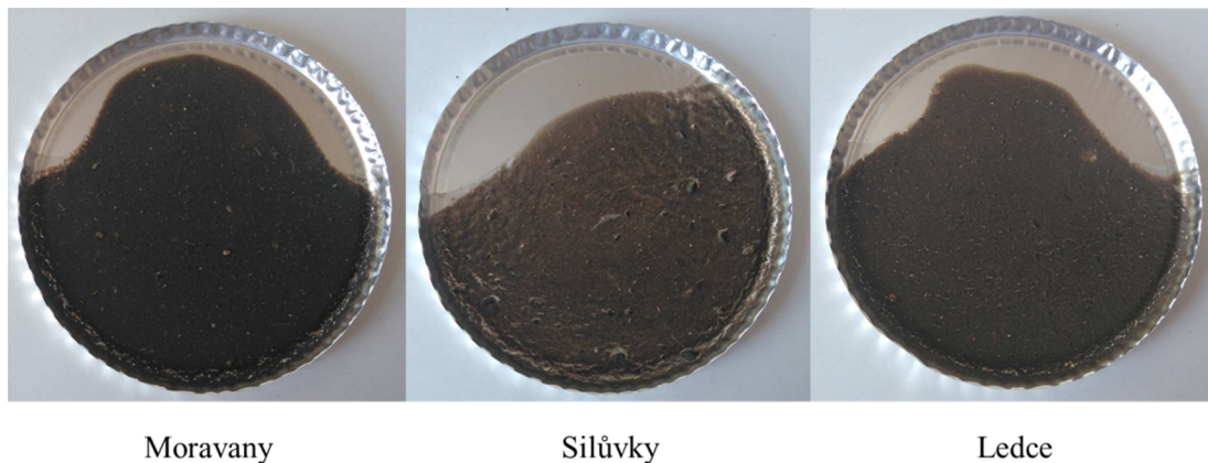
Obr. 7.6 Stanovení sušiny u surových aerobně stabilizovaných kalů
