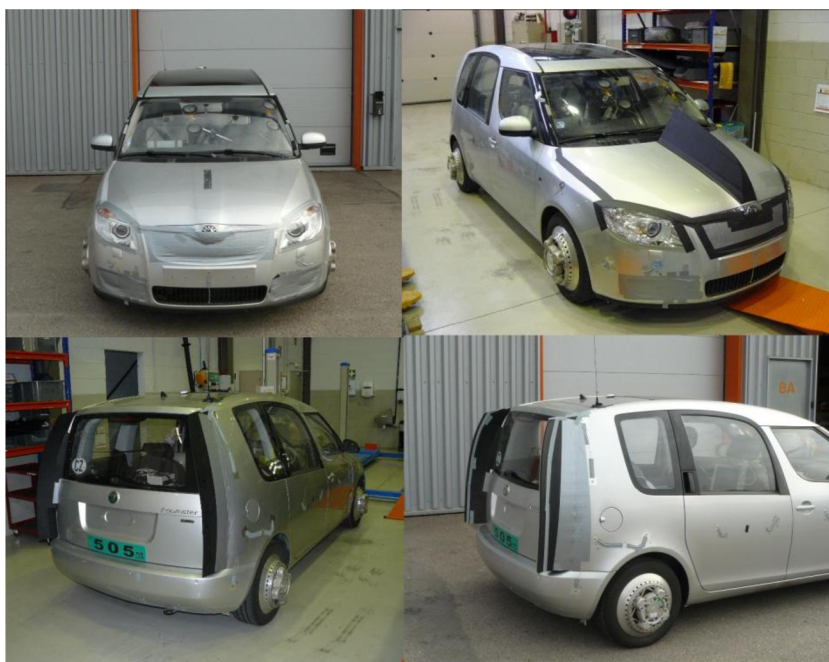
Obr. 2.15 Konfigurace Base (vlevo nahoře), Aero 1 (vpravo nahoře), Aero 2 (vlevo dole), Aero 3 (vpravo dole) [3]
