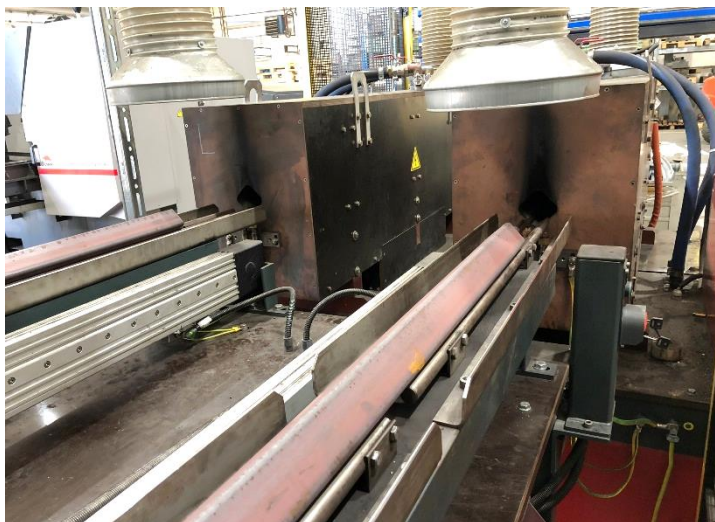
Obr. 45 Indukční pec pro ohřev polotovarů
