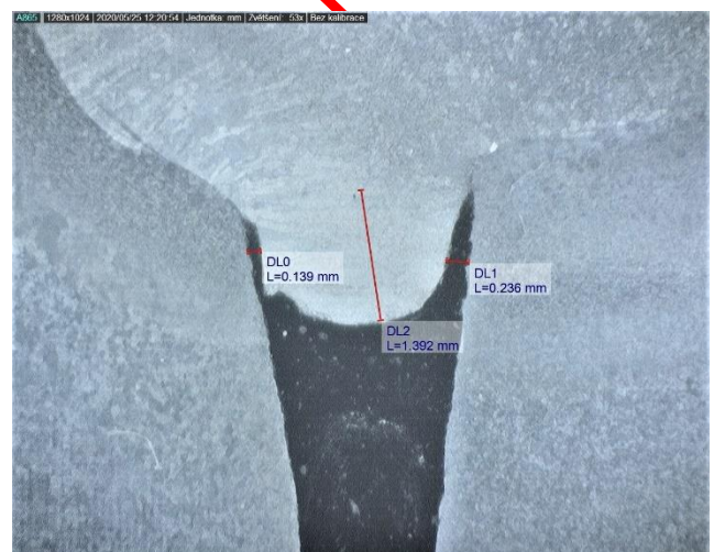
Obr. 5 Vady v kořeni svaru
