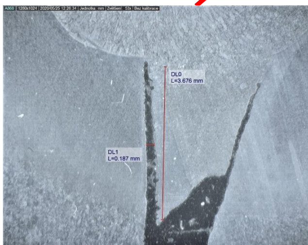
Obr. 4 Vady v kořeni svaru
