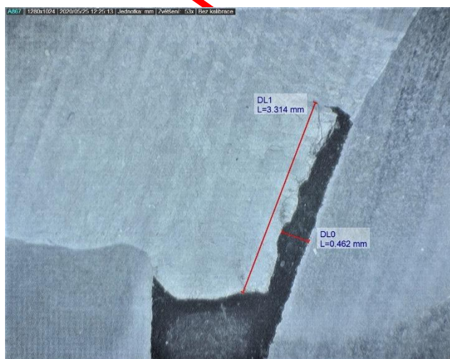
Obr. 4 Vady v kořeni svaru
