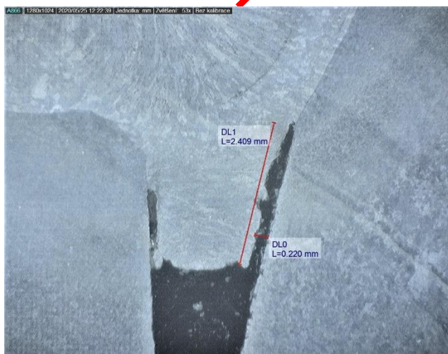
Obr. 4 Vady v kořeni svaru
