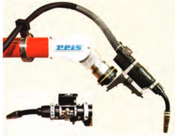
Obr. 23 Technologická výstupní hlavice pro obloukové svařování [24]
