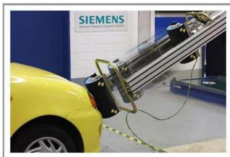
Obrázek 15: Provedení testu s impaktorem stehna [39]
