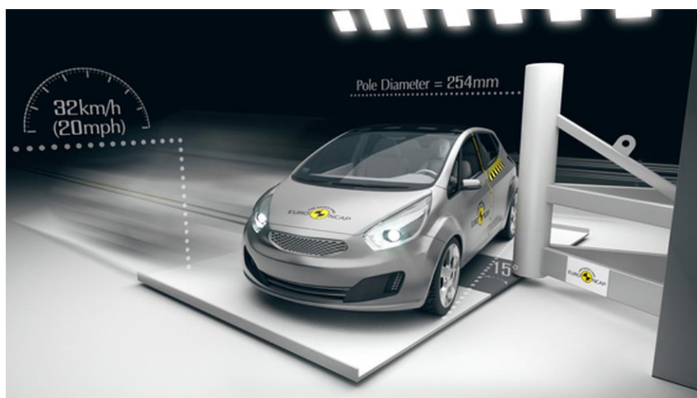
Obrázek 5: Schéma testu bočního nárazu na sloup [29]
