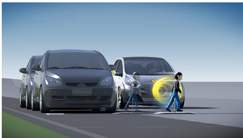
Obrázek 17: Autonomní nouzové brzdění na rozpoznání chodce [42]
