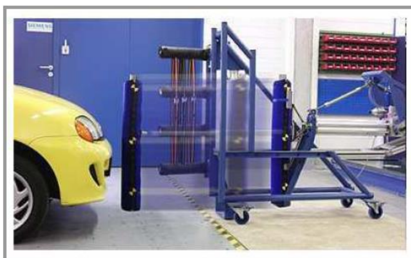
Obrázek 16: Průběh testu s impaktorem dolní končetiny [39]
