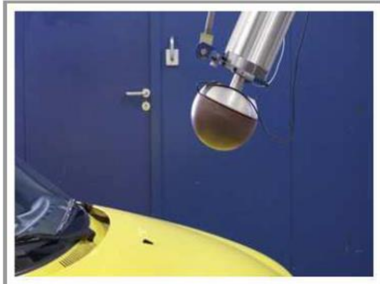
Obrázek 14: Průběh testu s impaktorem hlavy [39]
