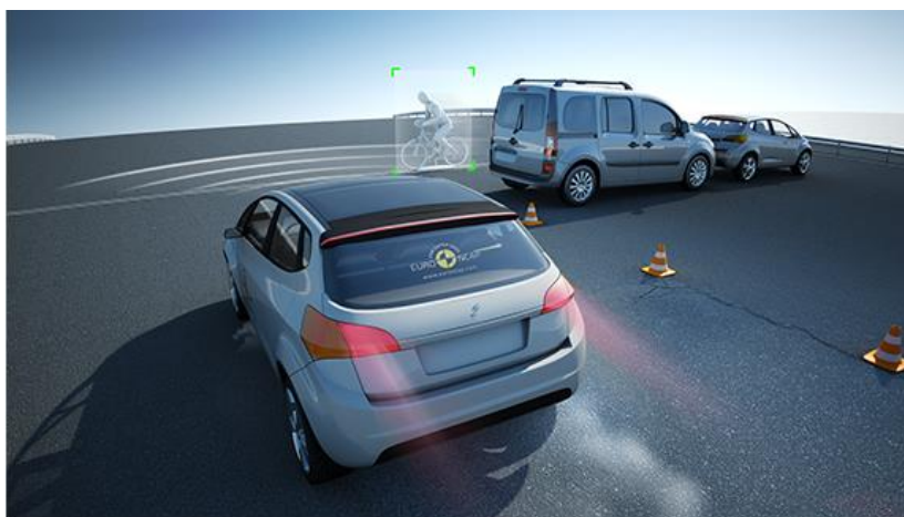
Obrázek 18: Autonomní nouzové brzdění na rozpoznání cyklisty [43]
