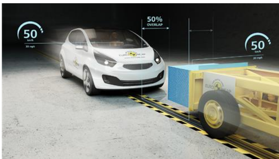
Obrázek 2: Čelní náraz do mobilní deformovatelné bariéry [26]
