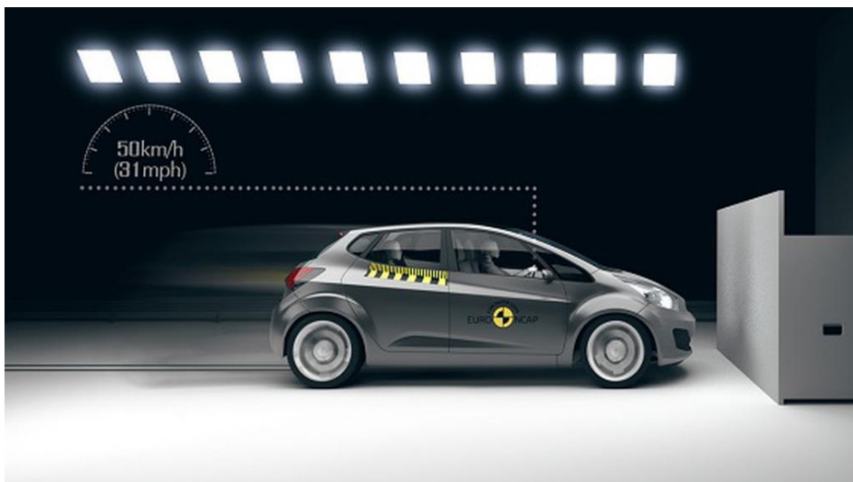
Obrázek 3: Plný čelní náraz do nedeformovatelné bariéry [27]
