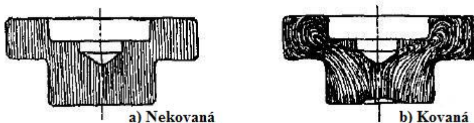
Obr. 22 Rozdíly vláken kované a nekované součásti [21]
