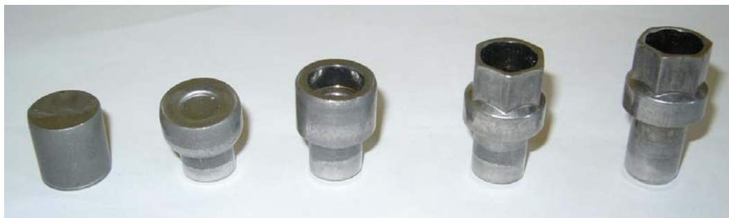
Obr. 34 Postup tváření tělesa zapalovací svíčky
