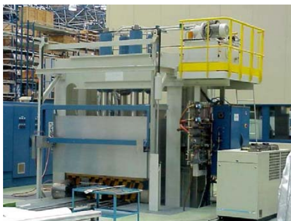
Obr. 29 Stroj pro tváření superplastických materiálů [25]
