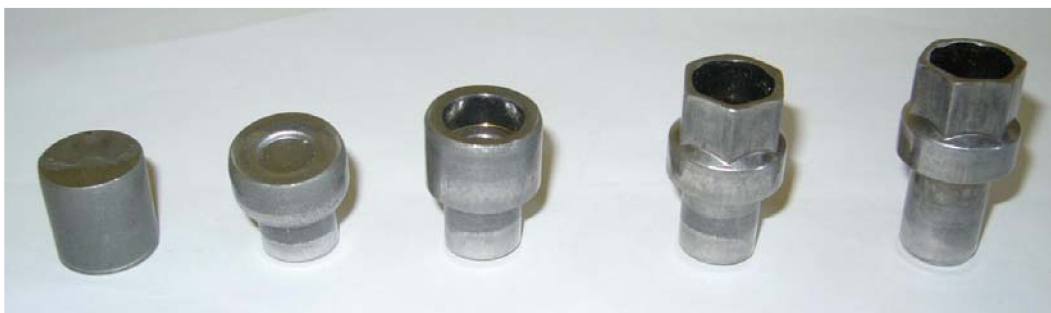
Obr. 34 Postup tváření tělesa zapalovací svíčky
