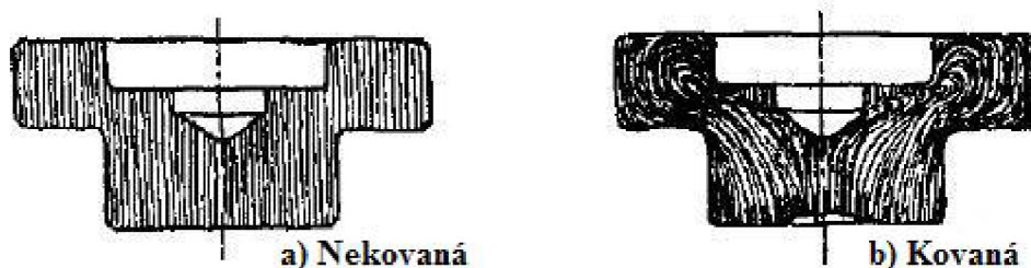
Obr. 22 Rozdíly vláken kované a nekované součásti [21]
