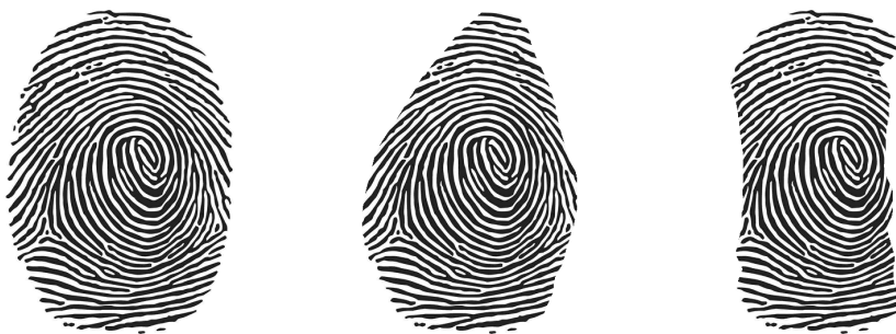
Obr. 5.11: Ukážka výsledkov požadovaných po použití algoritmu pre aplikovanie neprirodzeného tvaru odtlačku. Vľavo je pôvodný odtlačok, nasledujú dva obrázky rovnakého odtlačku, ktoré boli orezané rôznymi maskami.
