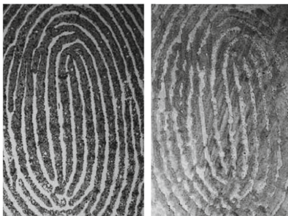
Obr. 3.2: Rozdiel medzi pravým a falošným odtlačkom prsta zanechaným odliatkom vyrobeným metódou výroby plošných spojov. Vľavo je originálny odtlačok prsta, vpravo falzifikát. Odtlačky sú vizualizované optickými technikami. Obrázok bol prebraný a upravený z [8].
