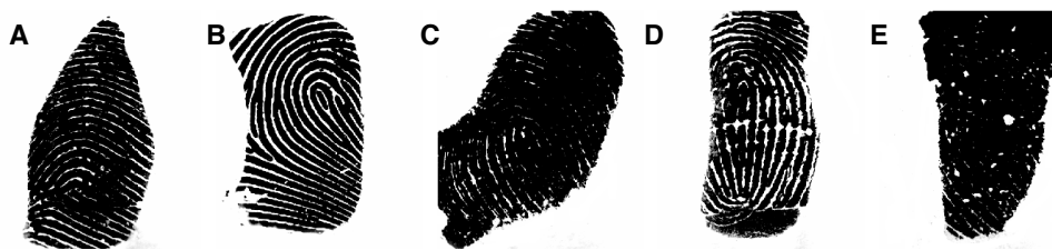
Obr. 5.8: Rôzne tvary falzifikátov z databázy výskumnej skupiny STRaDe. Na obrázkoch sú prítomné príliš rovné okraje, konkávny tvar falzifikátov, falzifikáty pripomínajúce obdĺžnikové alebo lichobežníkové útvary.
