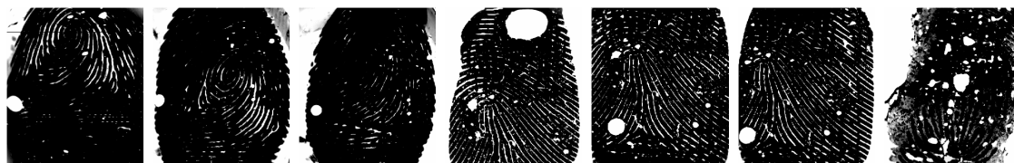
Obr. 5.1: Obrázky falzifikátov s prítomnými vzduchovými bublinami z databázy výskumnej skupiny STRaDe (Security Technology Research and Development), ktorá pôsobí na Vysokém učení technickém, Fakultě informačních technologií v Brne.
