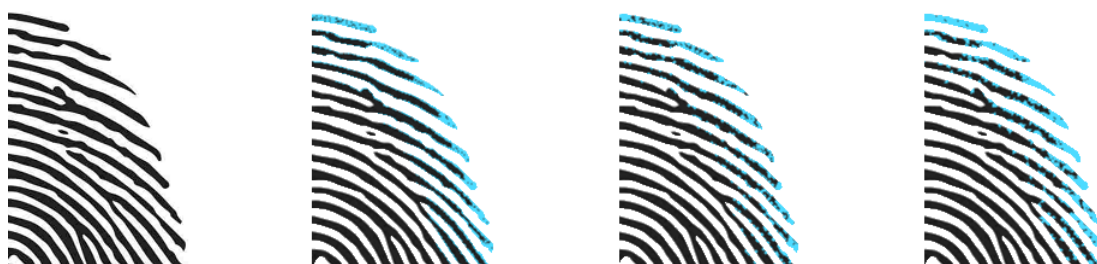
Obr. 5.6: Poškodenie okrajov papilárnych línií požadované ako výsledok navrhnutého algoritmu. Úplne vľavo je výrez z odtlačku bez poškodenia okrajov papilárnych línií. Nasledujú výrezy z rovnakého odtlačku po aplikovaní poškodenia okrajov s rôznou intenzitou, narastajúcou smerom doprava. Útvary generované pre dosiahnutie poškodenia sú na obrázku kvôli lepšej názornosti zobrazené modrou farbou.
