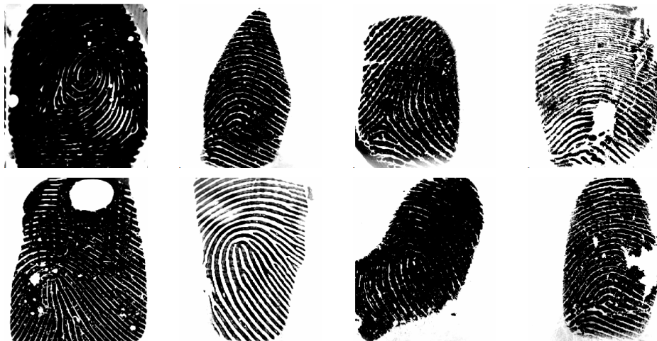
Obr. 3.4: Rôzne artefakty falzifikátov. V prvom stĺpci zľava sú obrázky falzifikátov s prítomnými vzduchovými bublinami. V druhom stĺpci zľava sa nachádzajú falzifikáty s celkovým tvarom odlišným od prírodného tvaru odtlačku, ďalším artefaktom v týchto odtlačkoch je náhle ukončenie papilárných líní. V treťom stĺpci zľava sú v odtlačkoch falzifikátov veľmi úzke medzery medzi papilárnymi líniami v porovnaní so šírkou papilárných líní. V štvrtom stĺpci zľava sú znázornené odtlačky falzifikátov s chýbajúcimi regiónmi. Zároveň je na všetkých odtlačkoch možné pozorovať absenciu potných pórov.
