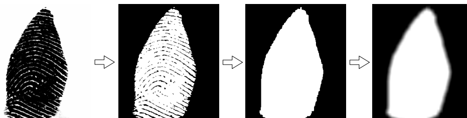
Obr. 5.10: Postup získania masky tvaru falzifikátu, vhodnej pre orezanie syntetického odtlačku prsta. Najskôr sú prahovaním detegované papilárne línie. Následne je riadkovým vyplňaním vytvorená čierno-biela reprezentácia tvaru falzifikátu. Nakoniec je maska vyhladená pre zjemnenie okrajov, aby mohla byť použitá pri orezaní.
