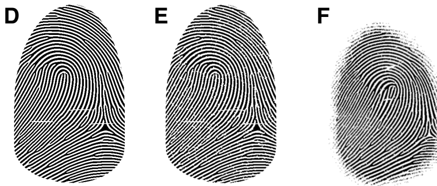
Obr. 6.3: Porovnanie pridania mierneho poškodenia papilárnych línií do hlavného odtlačku: D – Hlavný odtlačok z generátora SFinGe s plynulými papilárnymi líniami, E – výsledok metódy damageLines() , F – syntetický odtlačok prsta z generátora SFinGe.
