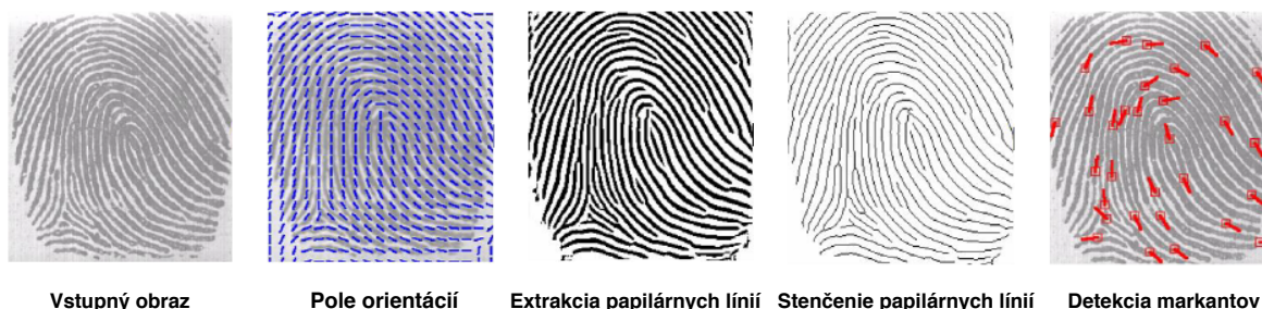
Obr. 2.6: Schematicky znázornené výstupy jednotlivých krokov procesu získania reprezentácie odtlačku prsta zo vstupného obrazu. Obrázok bol prebraný a upravený z [6].
