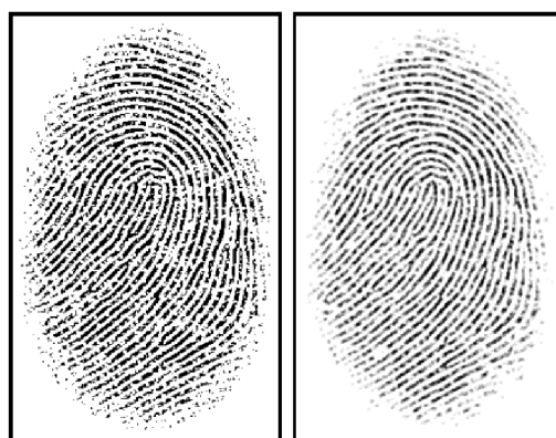
Obr. 4.3: Pridanie šumu do obrázka odtlačku prsta. Vľavo je znázornený stav po pridaní bielych škvŕniiek do obrázka odtlačku. Vpravo je finálny obrázok odtlačku so šumom po vyhladení a prekrytí uloženou vrstvou bielych pixelov, reprezentujúcich medzery medzi papilárnymi líniami. Obrázok bol prebraný z [13].
