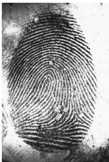
Obr. 3.3: Falzifikát odtlačku prsta vyrobený prenesením stopy odtlačku prsta pomocou lepidla a detegovaný hliníkovým práškom. Obrázok bol prebraný z [8].
