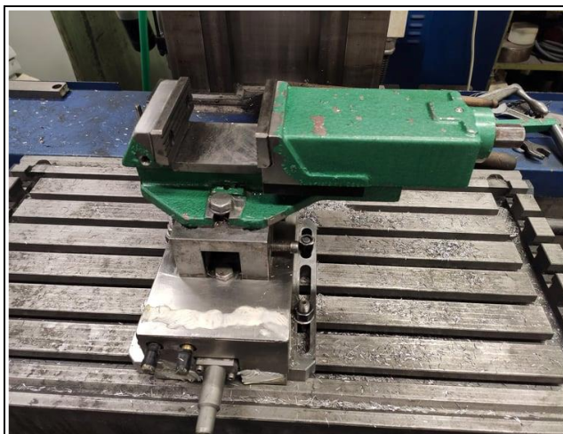
Obr. 3.16 Dynamometr KYSTLER a siloměr
