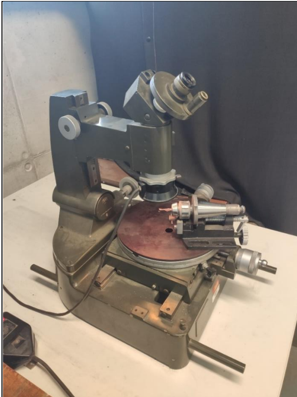
Obr. 3.21 Mikroskop ZEISS a nitkový kříž v okuláru
