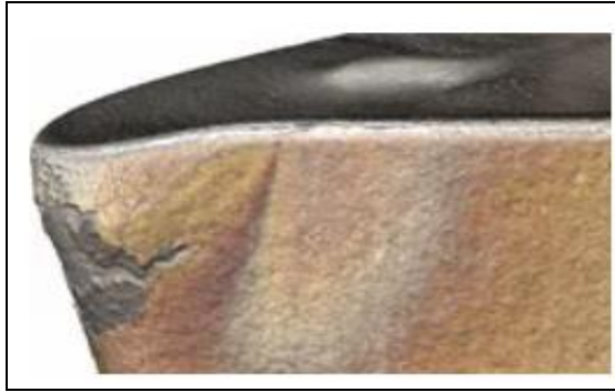
Obr. 2.6 Chemické opotřebení břitu [8]
