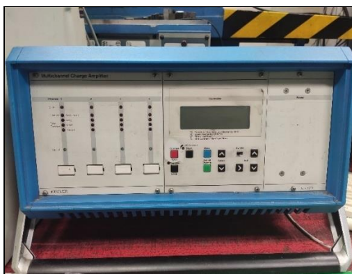
Obr. 3.17 Nábojový zesilovač a detail působení sil
