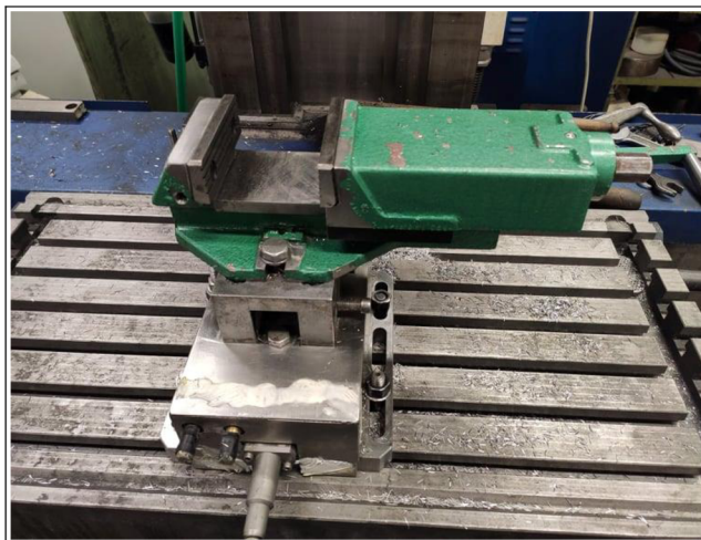
Obr. 3.16 Dynamometr KYSTLER a siloměr
