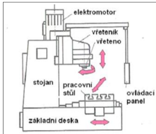
Obr. 3.12 Schéma univerzální konzolové frézky [10]
