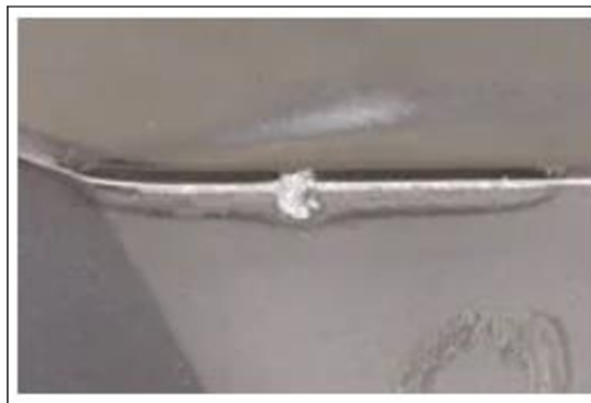
Obr. 2.7 Opotřebení břitu křehkým lomem [8]
