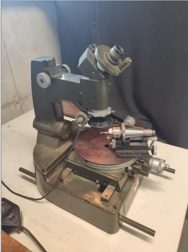
Obr. 3.21 Mikroskop ZEISS a nitkový kříž v okuláru
