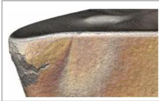
Obr. 2.6 Chemické opotřebení břitu [8]
