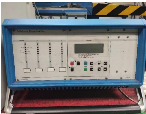
Obr. 3.17 Nábojový zesilovač a detail působení sil
