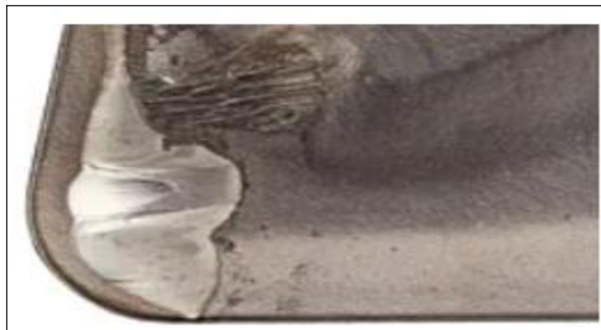
Obr. 2.5 Chemické opotřebení břitu [8]
