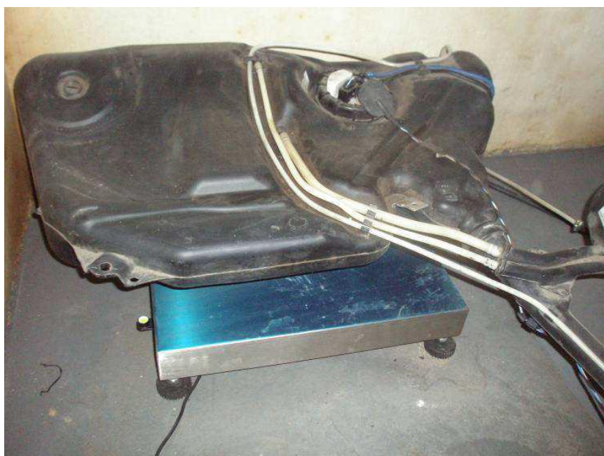
Obr. 64 Umístění nádrže na plošinové váze
