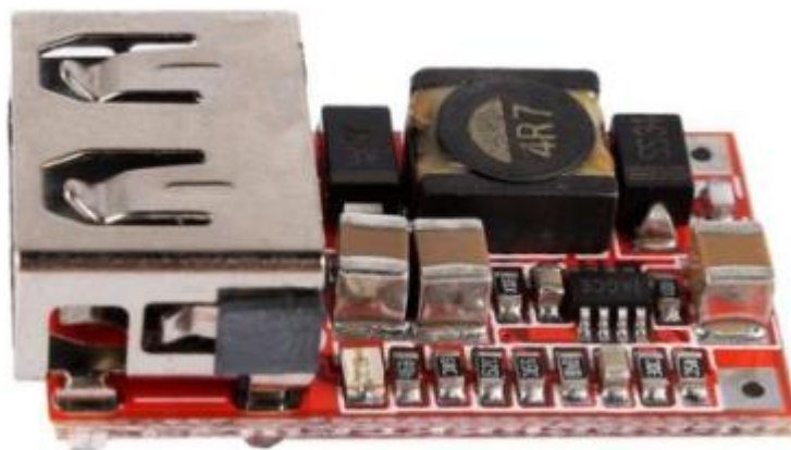
Obrázek 48. Měníč napětí 12/5V
