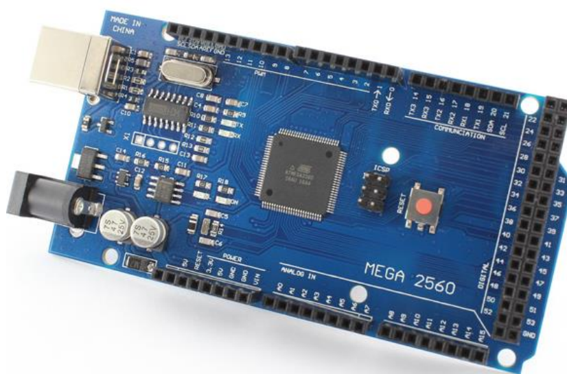
Obrázek 42. Klon Arduino Mega 2560
