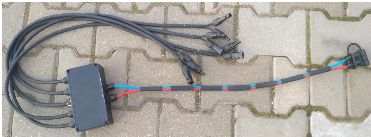
Obrázek 58. Propojovací box pro panely
