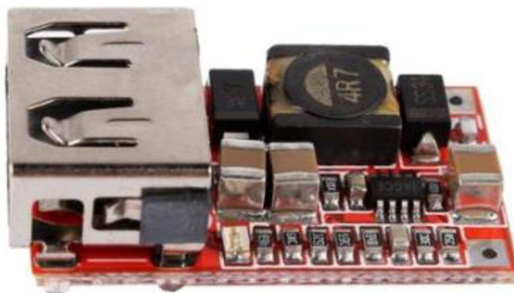
Obrázek 48. Měníč napětí 12/5V
