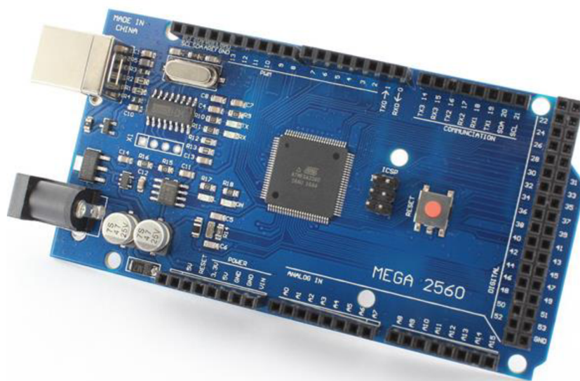
Obrázek 42. Klon Arduino Mega 2560
