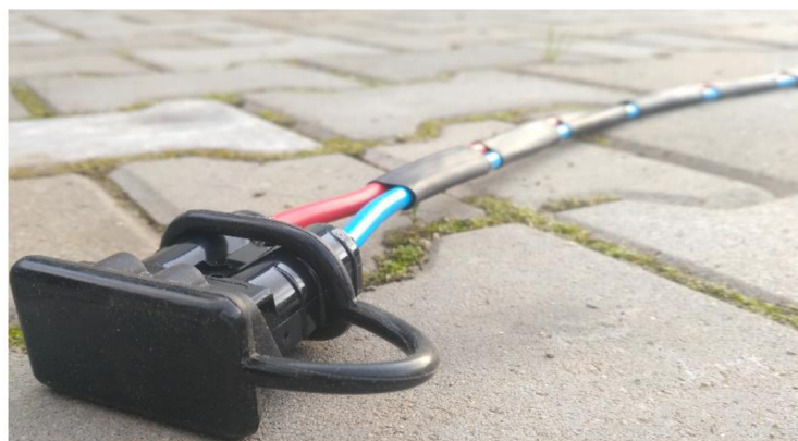
Obrázek 61. Anderson konektor pro připojení k elektrárně
