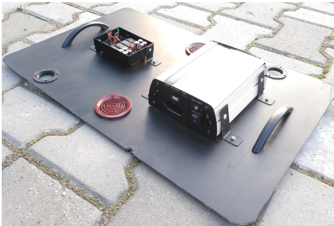
Obrázek 62. Usazení regulátoru a střídače
