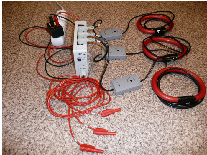
Obr. 15: Zapojený PQ monitor MEG 30 (vlevo) do jednofázové sítě nn s připojenými ohebnými snímači střídavých proudů AMOS PQ (vpravo)
