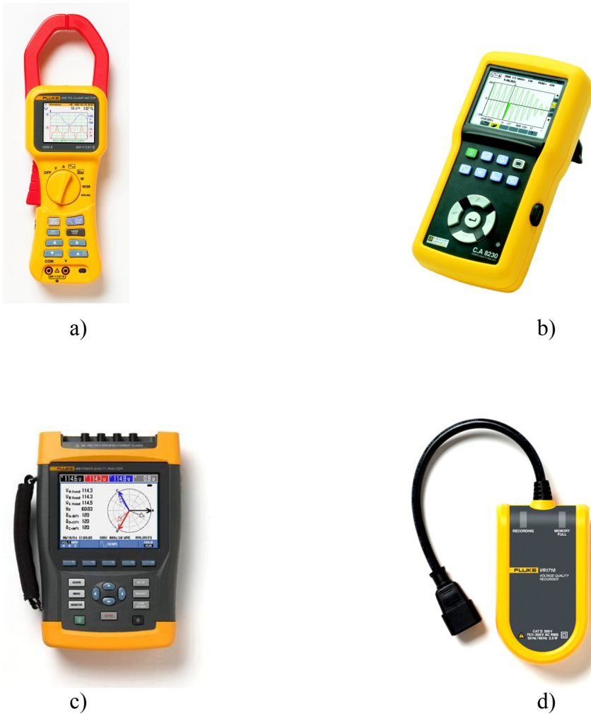
Obr. 3: a) Klešťový měřič, b) Jednofázový analyzátor, c) Třífázový analyzátor, d) Jednofázový záznamník (převzato z [1])
