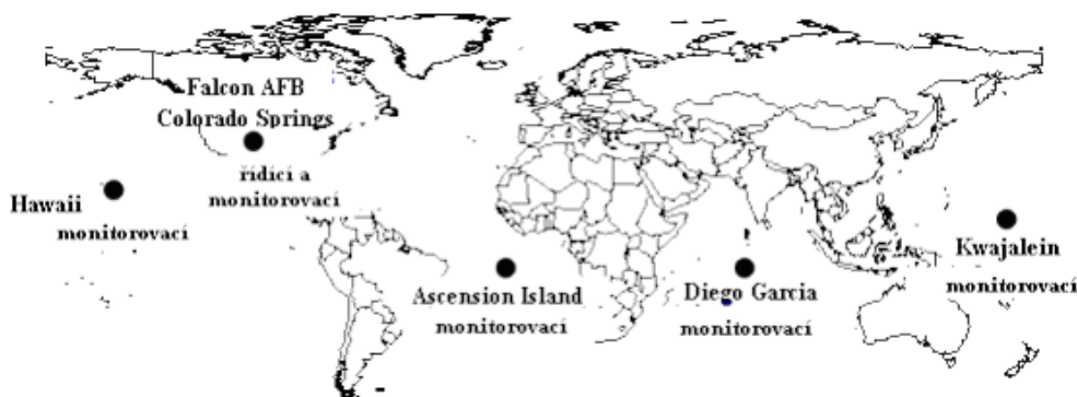
Obr. 4 Rozložení pozemních stanic kontrolního segmentu GPS [1]
