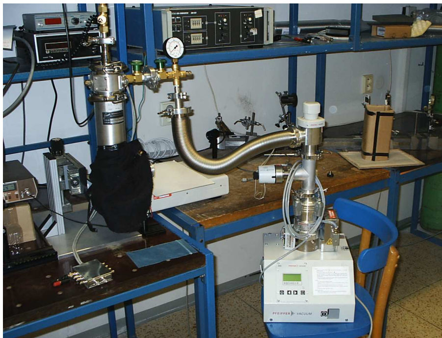
Obr. 38. Část pracoviště pro měření elektroluminiscence (Kryostat, vakuová pumpa)
