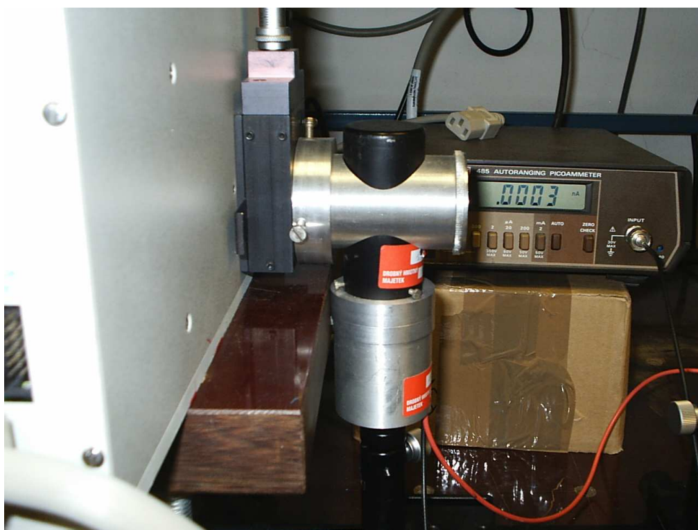
Obr. 40. Připevnění fotonásobiče na monochromátor
