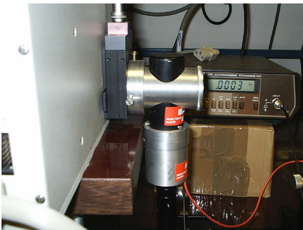
Obr. 40. Připevnění fotonásobiče na monochromátor
