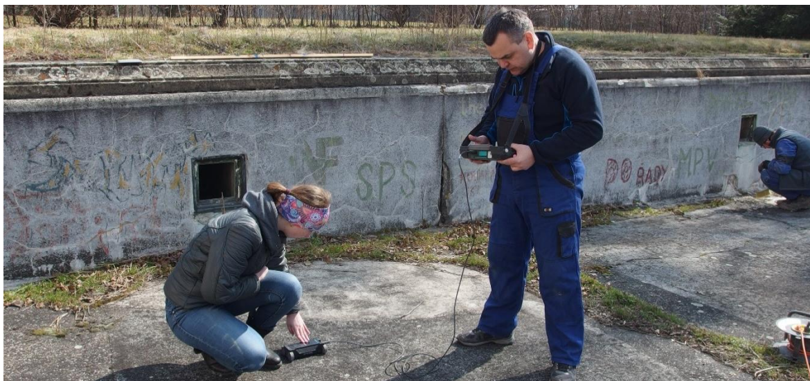
Obr. 7 Pořízení záznamu pomocí Profometru PM-630.
