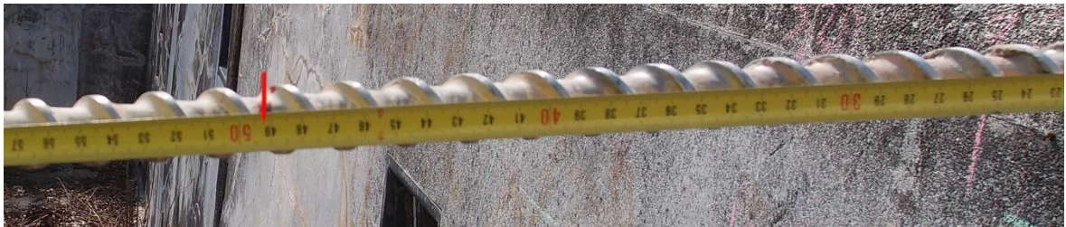
Obr. 48 Hodnota průvrtu stěny vyznačená na použitém vrtáku.
