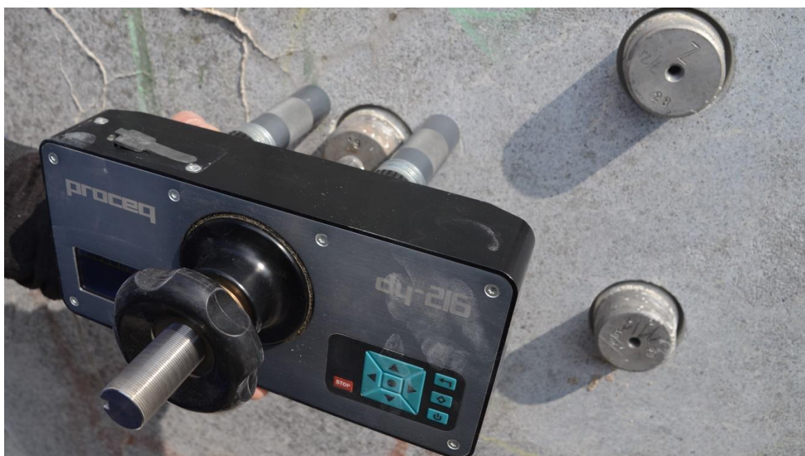
Obr. 4 Provádění odtrhové zkoušky.
