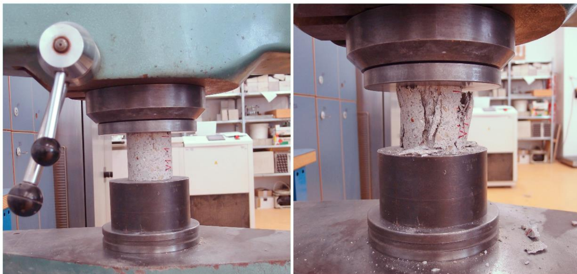
Obr. 52 Zkušební těleso v lisu, před zatížením a po zatížení.
