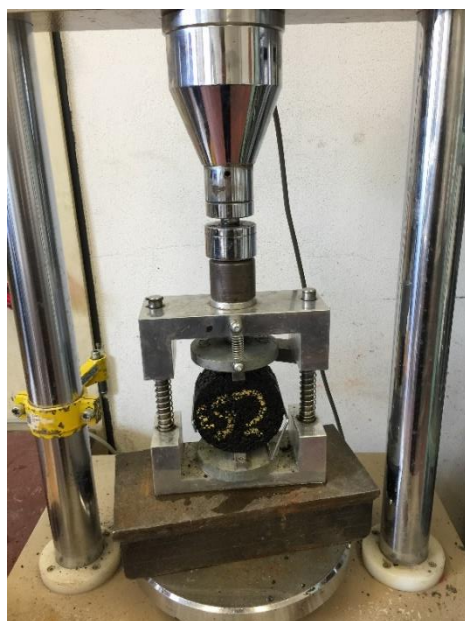
Obr. č. 24 Zkušební lis pro měření odolnosti vůči vodě
