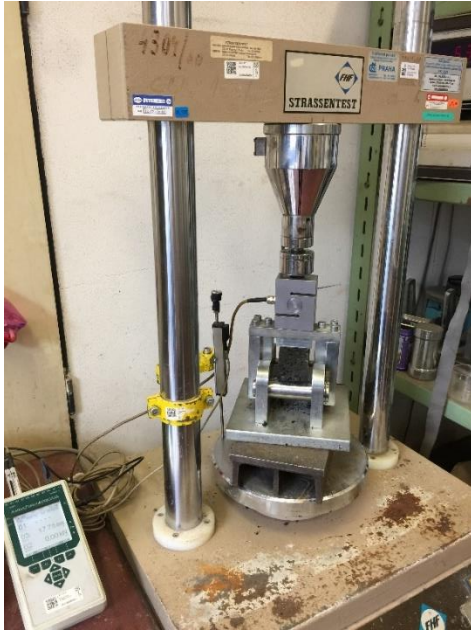
Obr. č. 25 Zkušební zařízení a snímací zařízení pro měření odolnosti vůči šíření trhlin
