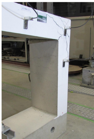
Obr. 5.4.10: GFRP A - I – porušenie prvku
