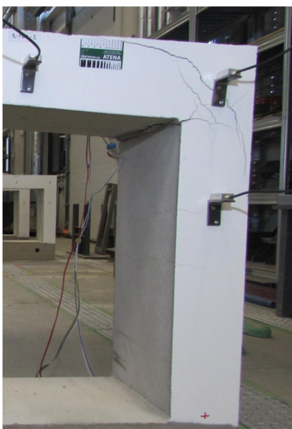
Obr. 5.4.17: GFRP B - II – rozvoj trhlín
