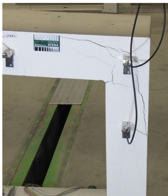
Obr. 5.4.5: ŽB A – rozvoj trhlín
