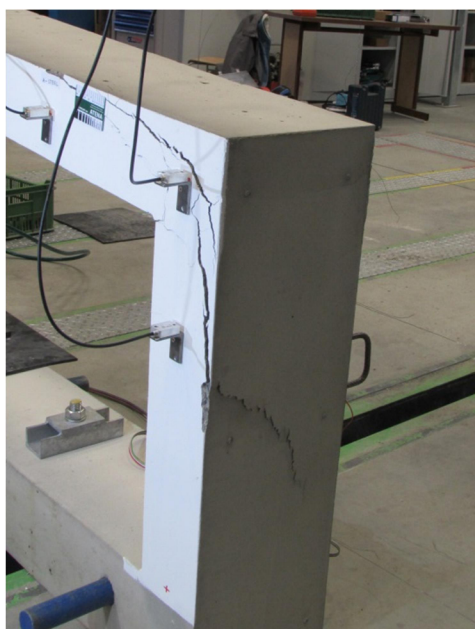
Obr. 5.4.6: ŽBA – porušenie prvku
