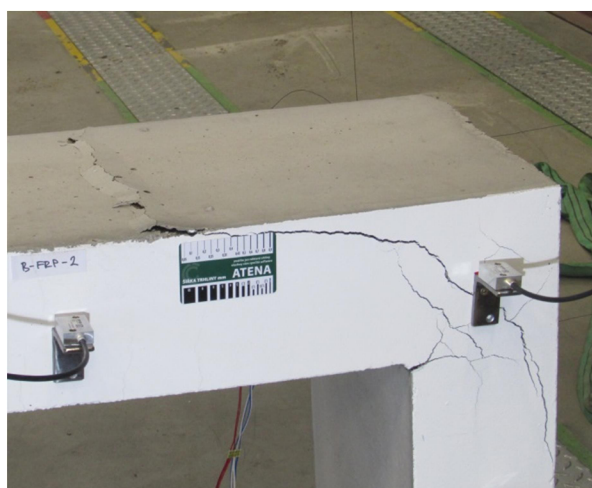
Obr. 5.4.18: GFRP A - I – porušenie prvku
