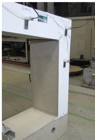
Obr. 5.4.10: GFRP A - I – porušenie prvku
