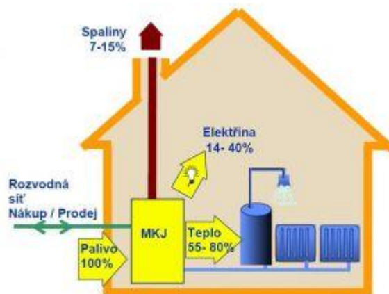
Obr. 3: Schéma mikrokogenerační jednotky v domě [7]
