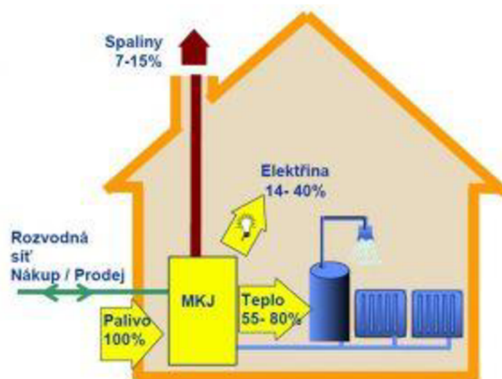
Obr. 3: Schéma mikrokogenerační jednotky v domě [7]
