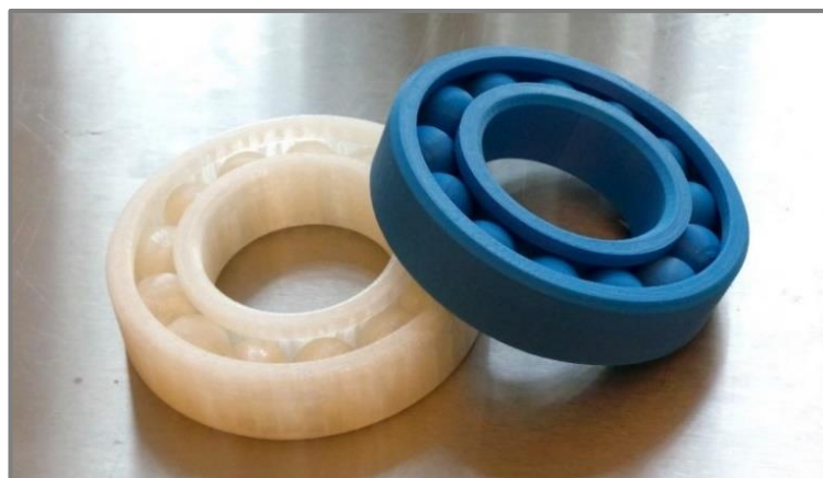
Obr. 2) Příklad nerozebíratelné sestavy – funkční ložisko [41]
