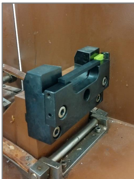
Obr. 64) Zkušební těleso umístěné na podpěrách
