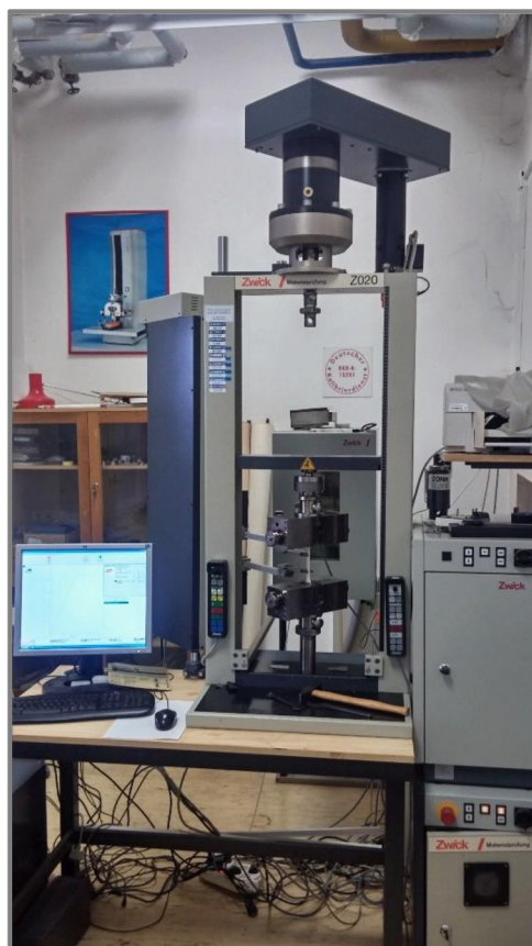
Obr. 46) Průběh tahové zkoušky na zařízení Zwick Z020
