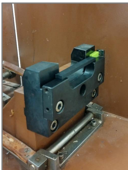
Obr. 64) Zkušební těleso umístěné na podpěrách
