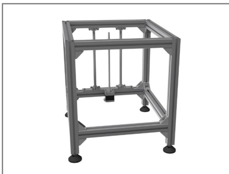
Obr. 30) Rám navržené 3D tiskárny
