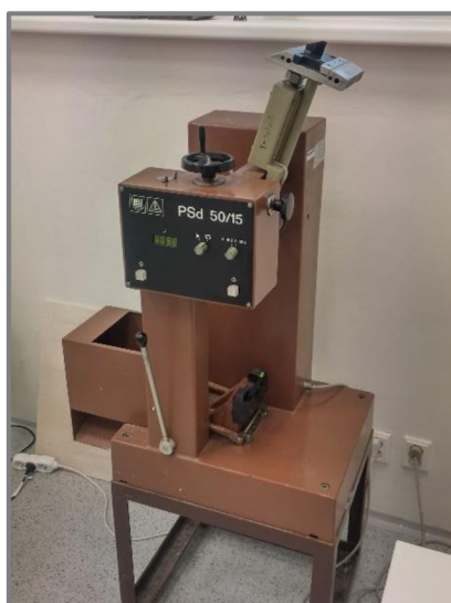
Obr. 65) Zařízení pro měření rázové/vrubové houževnatosti metodou Charpy
