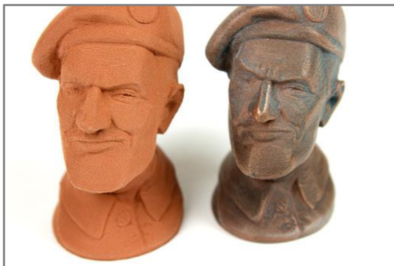
Obr. 11) Výtisk z materiálu s přídavkem mědi před (vlevo) a po vyleštění (vpravo) [30]
