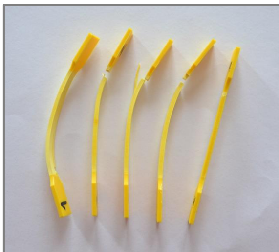
Obr. 61) Deformace vzorků z materiálu ABS
