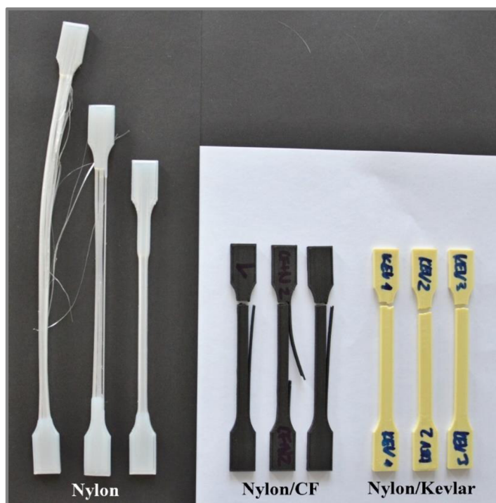
Obr. 58) Srovnání přetržených vzorků na bázi materiálu Nylon
