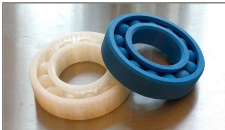
Obr. 2) Příklad nerozebíratelné sestavy – funkční ložisko [41]
