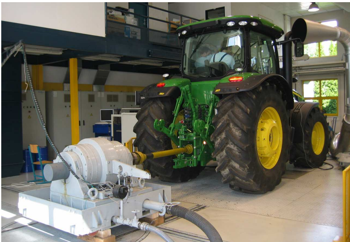
Obr. 18 Traktor JD 8320R při měření otáčkové charakteristiky v laboratoři Ústavu techniky a automobilové dopravy na Mendelu Brně
