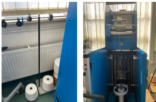
Obr. 3. Ukázka procesu skaní, a) jednoduché příze na cívkách s křížovým vinutím, b) proces skaní
