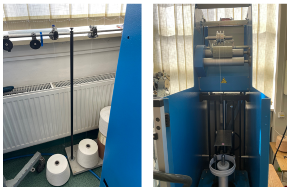
Obr. 3. Ukázka procesu skaní, a) jednoduché příze na cívkách s křížovým vinutím, b) proces skaní
