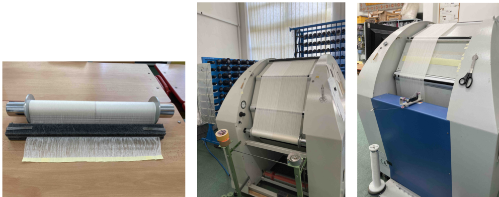
Obr. 4. Ukázka procesu snování pro experimentální sadu I, a) výsledný osnovní vále s příze s chitosanem a bez chitosanu, b) navinutá osnova na snovacím bubnu, c) proces snování
