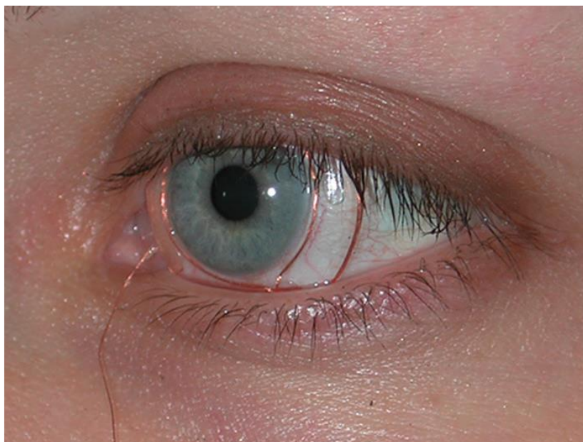
Obrázek 14 Kontaktní čočka s drátěnou cívkou
