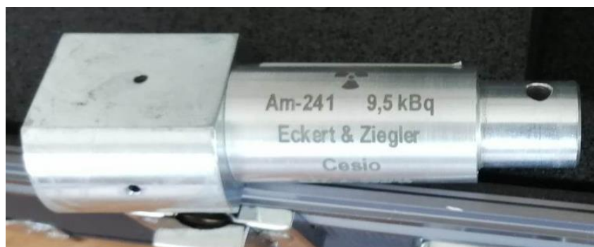
Obrázek 9: ^{241}\text{Am} zdroj záření \alpha .
