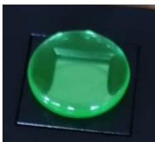
Obrázek 11: Uranové sklo jako zdroj záření \beta .
