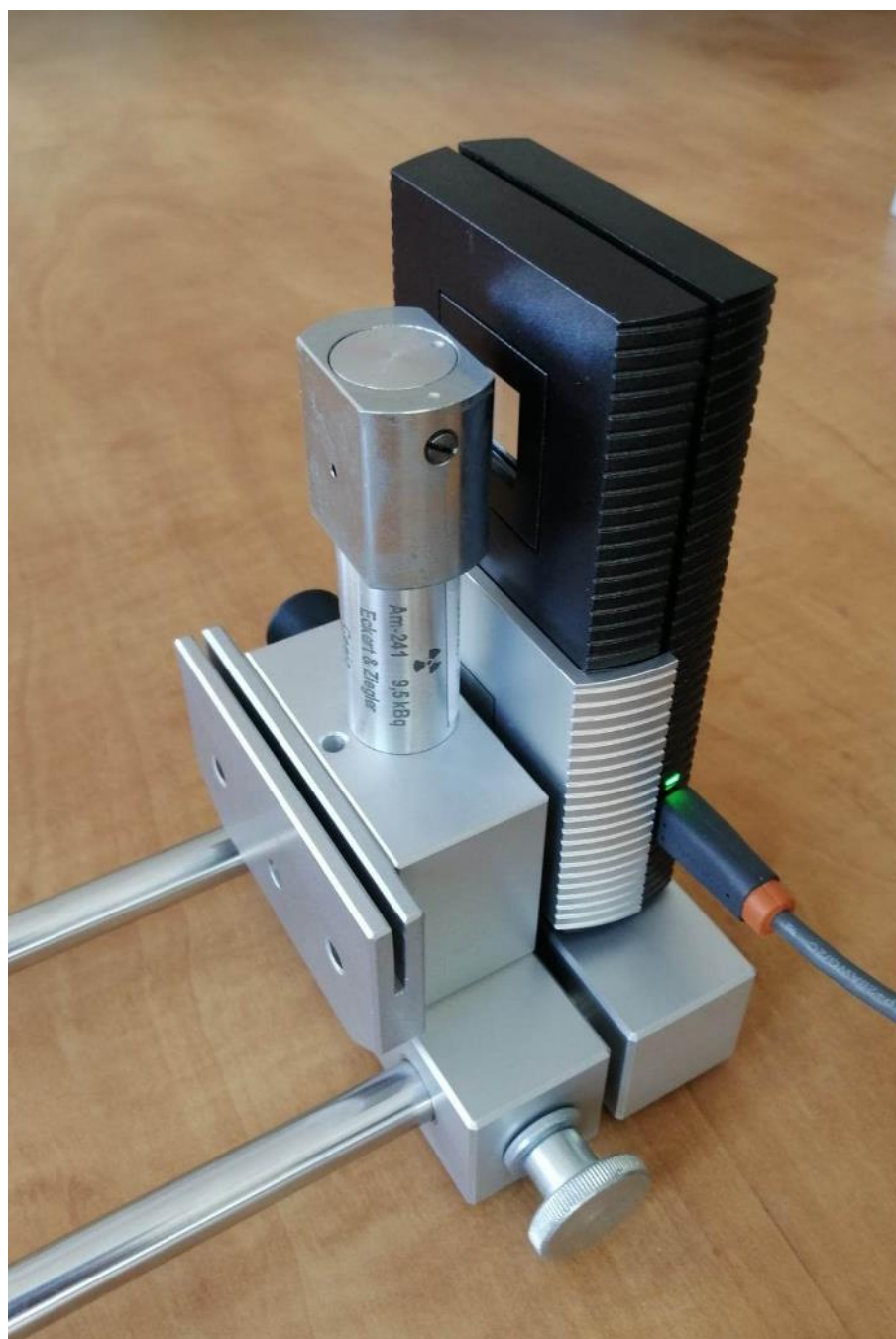
Obrázek 13: Sestava experimentu pro měření zdroje záření \alpha .
