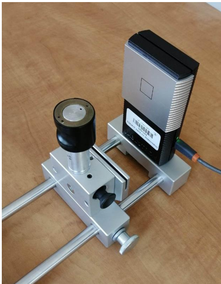
Obrázek 12: Sestava experimentu pro měření zdroje záření \gamma .
