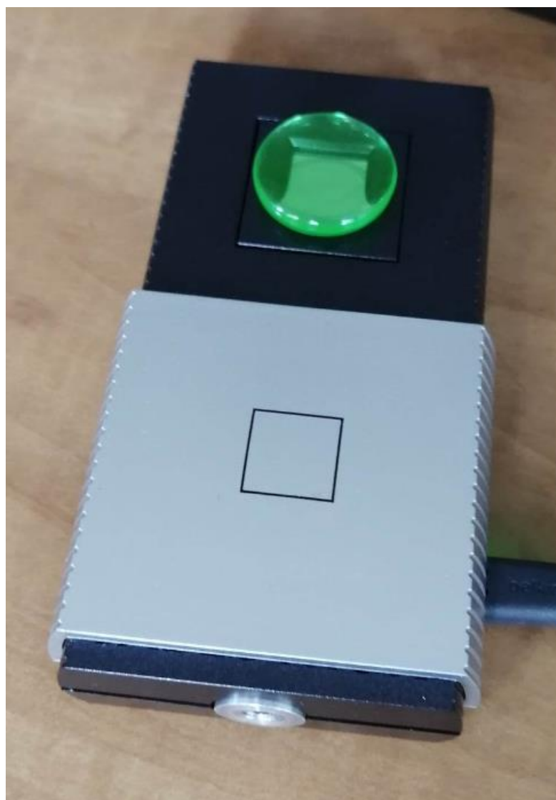
Obrázek 14: Sestava experimentu pro měření zdroje záření \beta .
