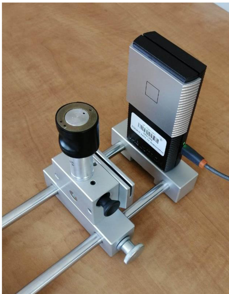
Obrázek 12: Sestava experimentu pro měření zdroje záření \gamma .
