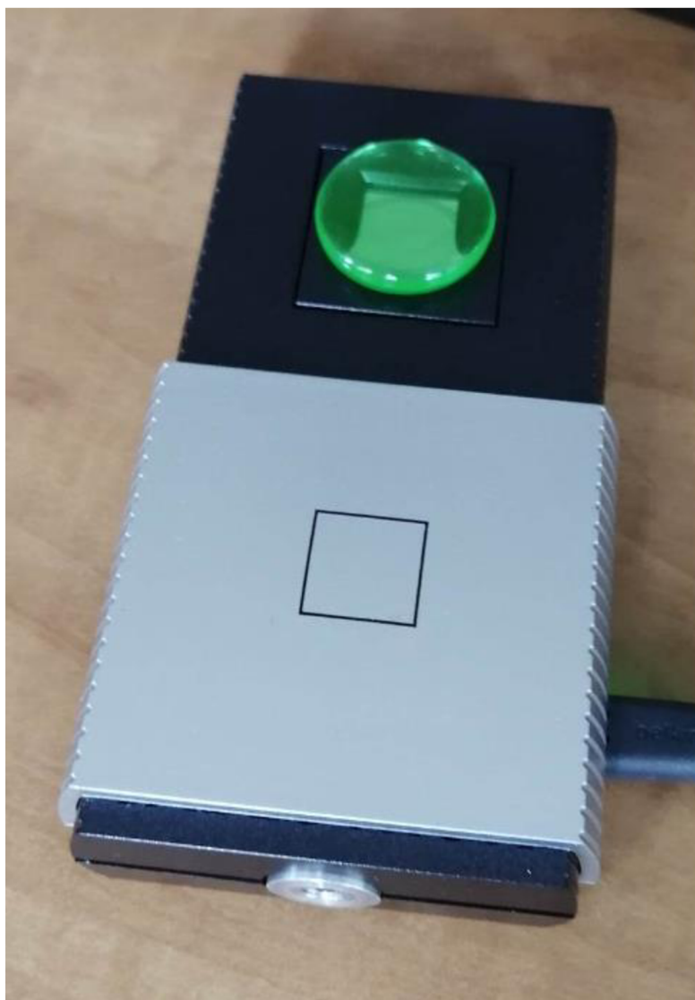
Obrázek 14: Sestava experimentu pro měření zdroje záření \beta .
