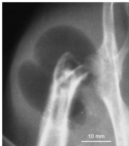
Obr. 1 Vznik vodíkové bubliny v tkáni při degradaci hořčíkového implantátu [23]
