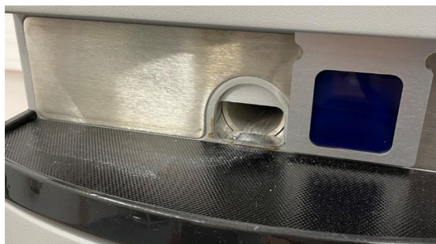
Obrázek 25 Detail spalovací pece analyzátoru LECO CHN628 + S
