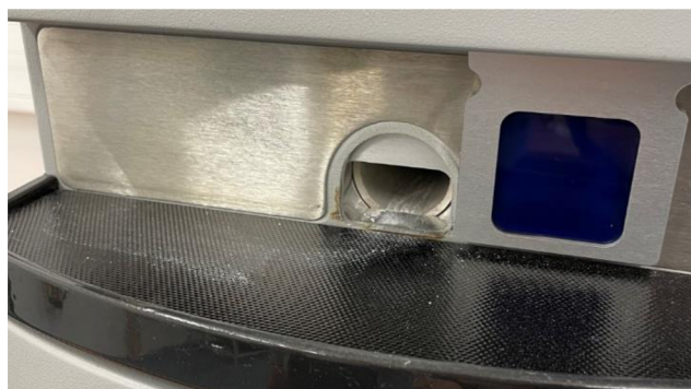
Obrázek 25 Detail spalovací pece analyzátoru LECO CHN628 + S
