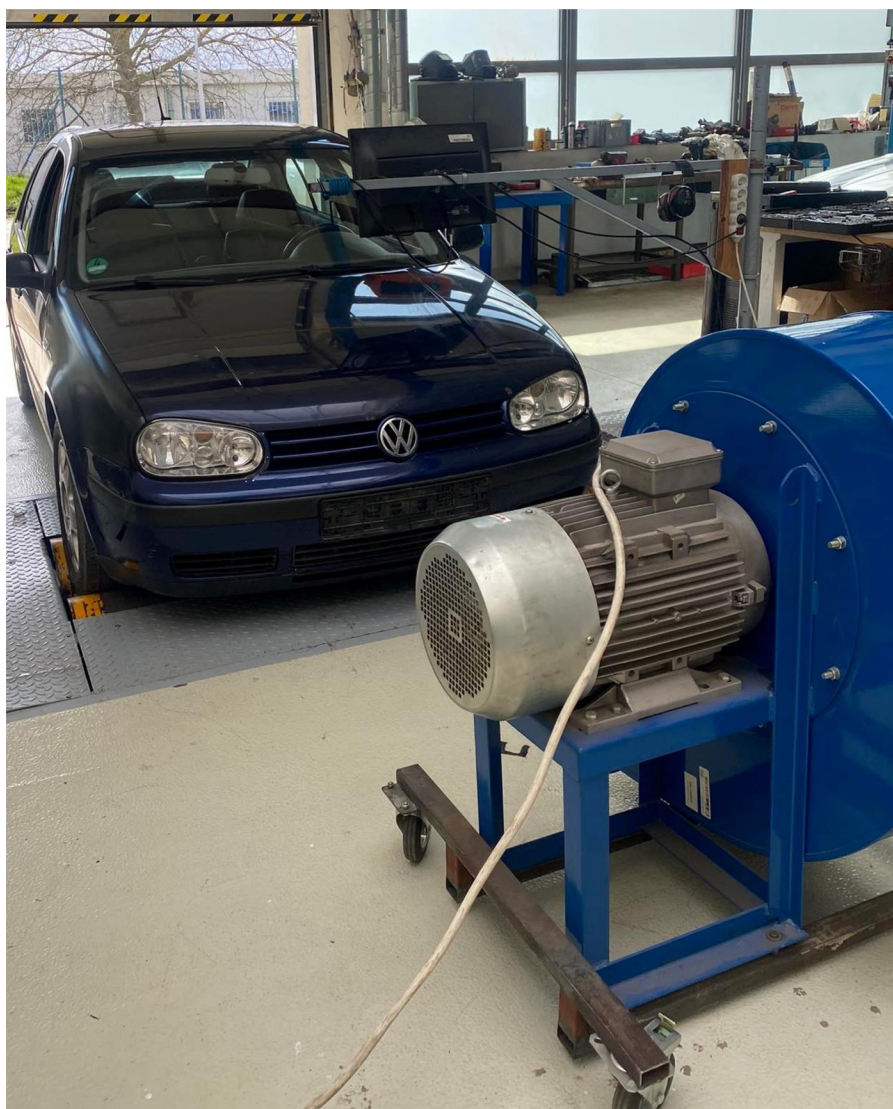
Obrázek 27 – Testovací vozidlo na válcové zkušebně
