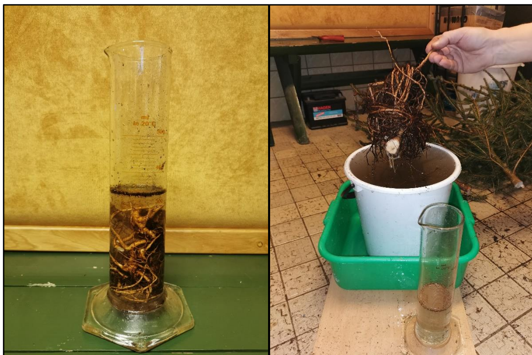
Příloha č. 15: Měření objemu menších K.S. (vlevo), měření objemu větších K.S. (vpravo)
