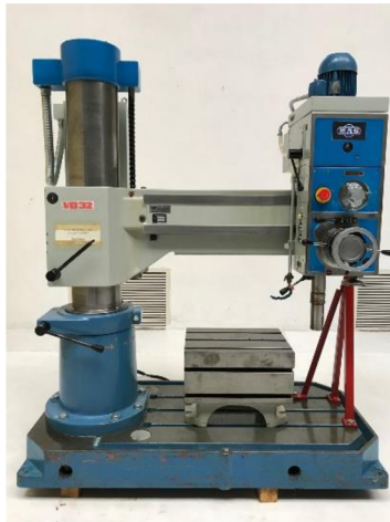
Obr. 20) Radiální vrtačka Kovosvit MAS VO 32 [24]
