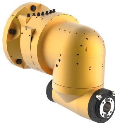
Obr. 5) Ortogonalní hlava TOS Varnsdorf HOIL 50 [6]
