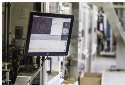
Obr. 2.8 Lemovací zařízení – na tomto obrázku je vidět kontrolní zařízení, kontrolující ovalitu uzávěru a správné uložení těsnění
