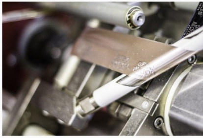
Obr. 2.7 Hotfoilový stroj – zde lze spatřit fólii, jak je pomocí čtočku přenášena na povrch uzávěru
