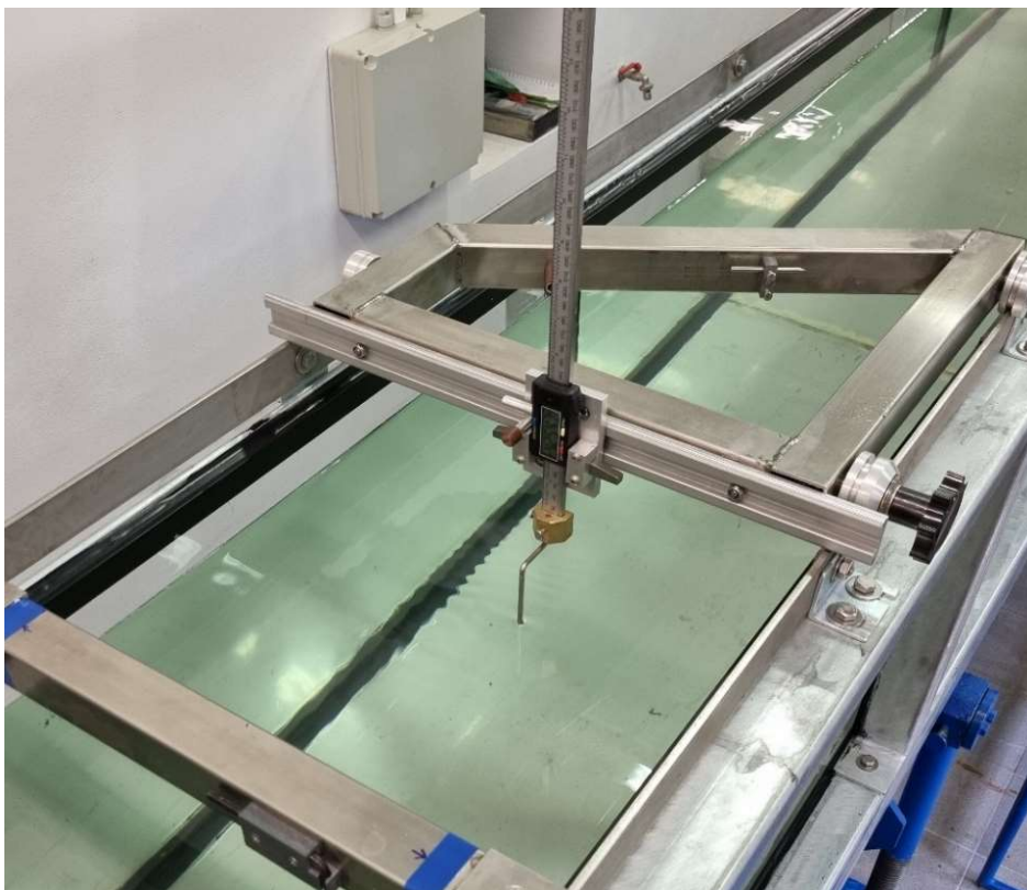
Obr. 6.5 Hrotová měřidlo umístěné na žlabu 40
