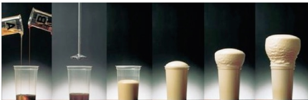
Obr. 1 Chemická reakce při výrobě PUR pěny
