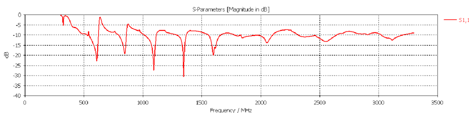
Obr. 2.3: Závislost S_{11} na kmitočtu - původní anténa
