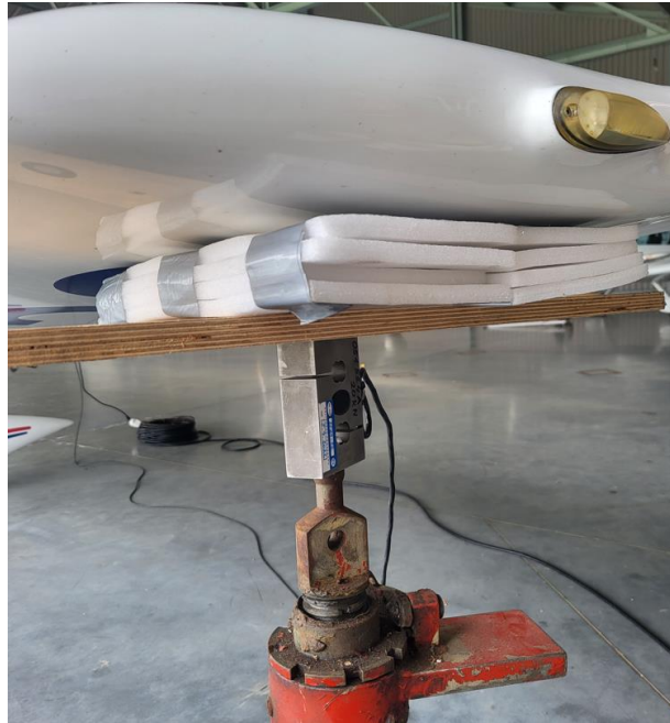
Obrázok 47 Zavedenie sily na krídlo pomocou zdviháku, kde tenzometer zaznamenáva veľkosť ohybu.
