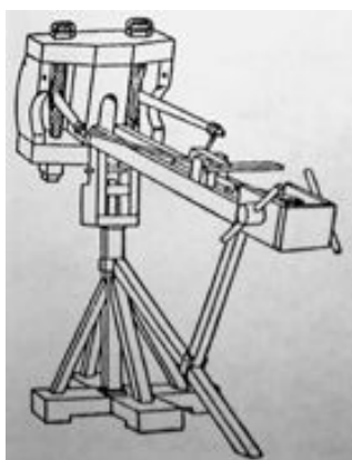
obr. 2.9b Katapulta (podle Vitruvia, římského architekta)
