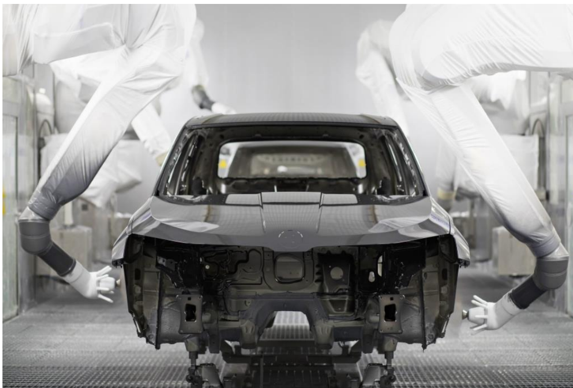
Obr. 6 Aplikace vrstvy barevného laku na karoserii pomocí robotů
