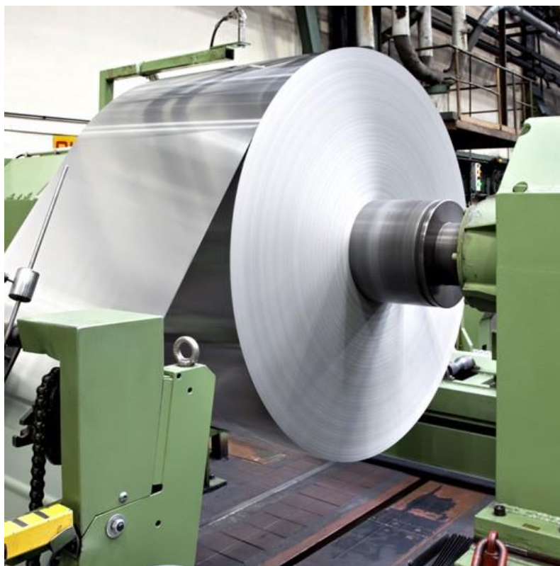
Obr. 2 Ukázka plechu ve svítku jako polotovaru pro následné zpracování
