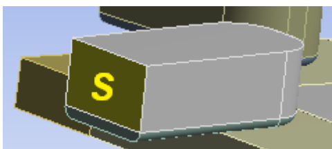
Obr. 29: Plocha označená písmenem S , na kterou jsou aplikovány okrajové podmínky Remote Displacement v rámci vymezení pohybu svorky a jejího zatížení.
