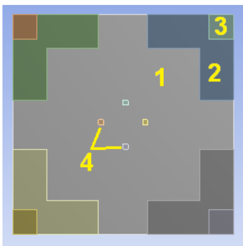
Obr. 21: Vzorek rozdělený na podoblasti: 1 Střed, 2 Pod svorkami, 3 Rohy, 4 Markery.
