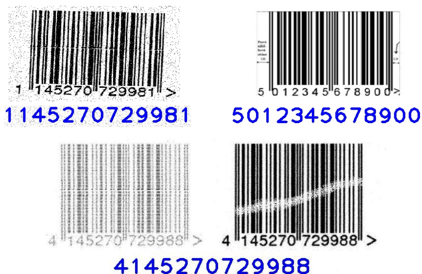
Obr. 7.15 Ukázka detekce poškozených čárových kódů
