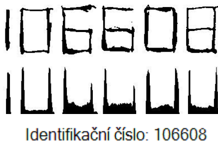
Obr. 6.10 Vertikální projekce identifikačního čísla a jeho klasifikace
