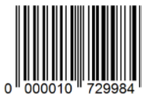
Obr. 5.6 Identifikace pomocí čárového kódu EAN-13
