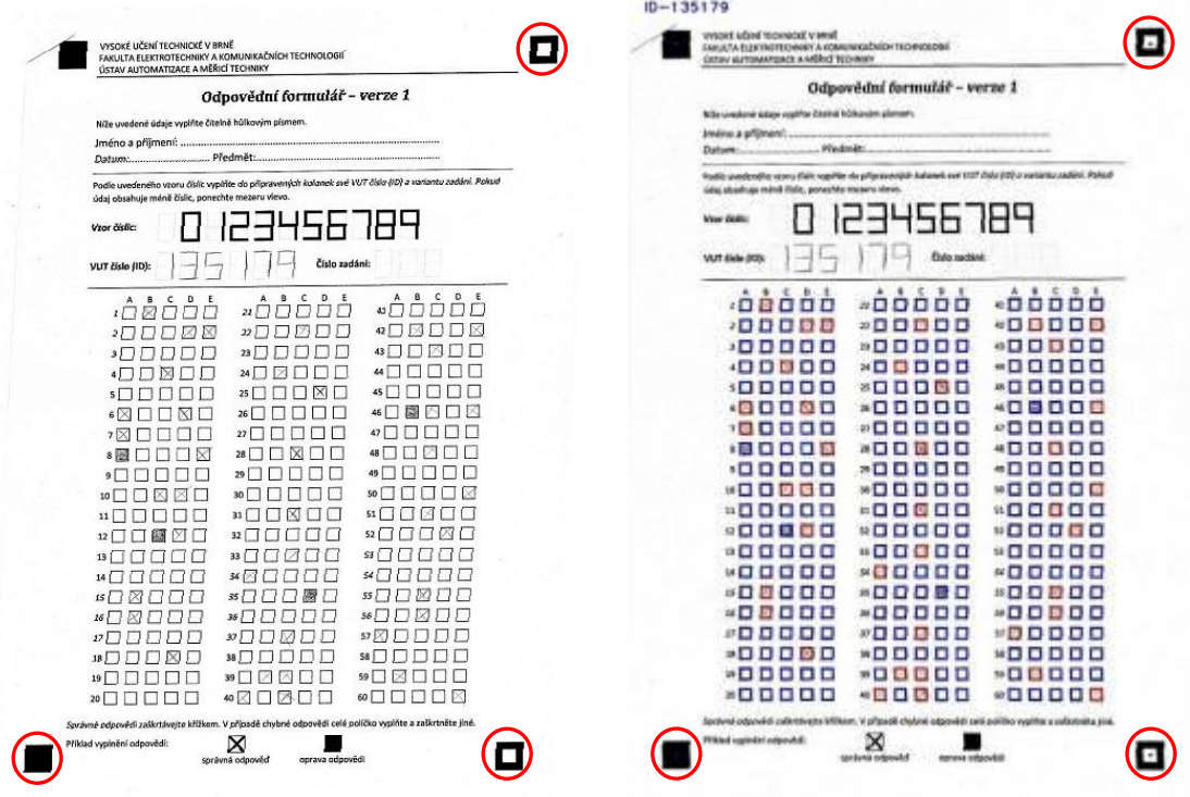
Obr. 7.2 Výsledek detekce zkosených čtvercových zaměř. značek – 3 nalezené
