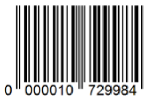
Obr. 5.6 Identifikace pomocí čárového kódu EAN-13
