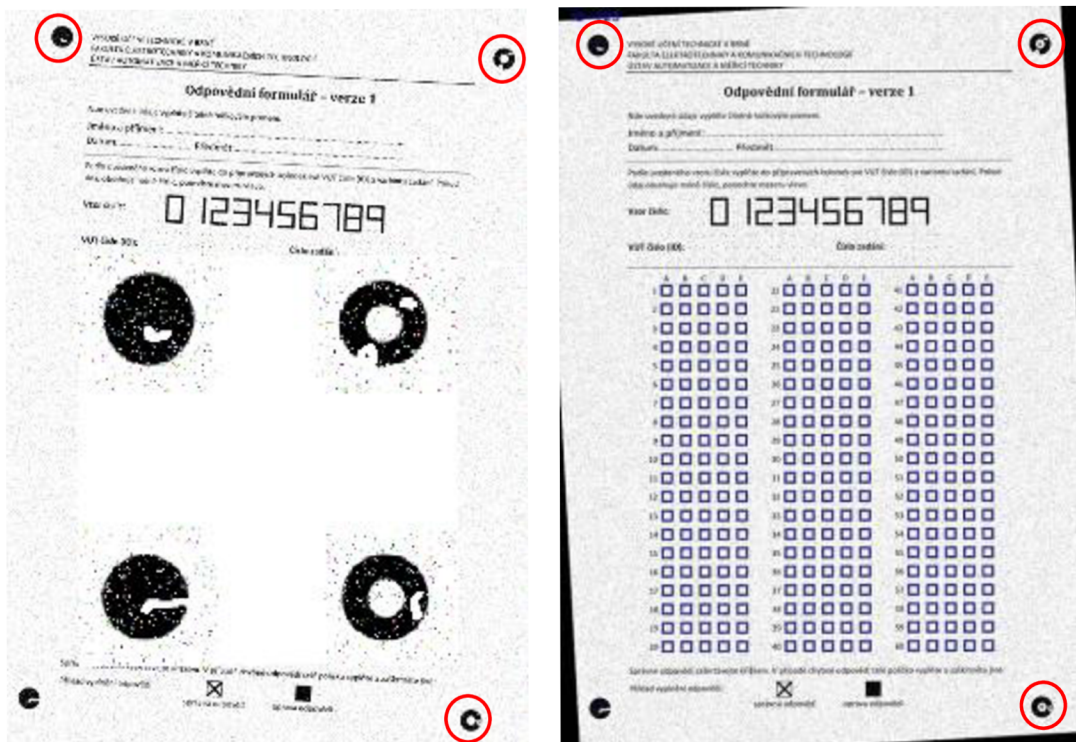
Obr. 7.3 Výsledek detekce poškozených kruhových zaměř. značek – 3 nalezené
