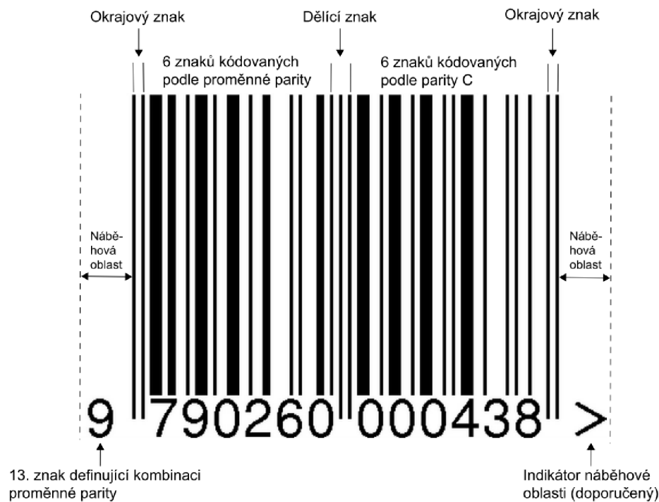
Obr. 3.16 Struktura čárového kódu EAN-13
