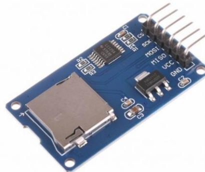
Obrázek č. 25 – Modul pro micro SD kartu
