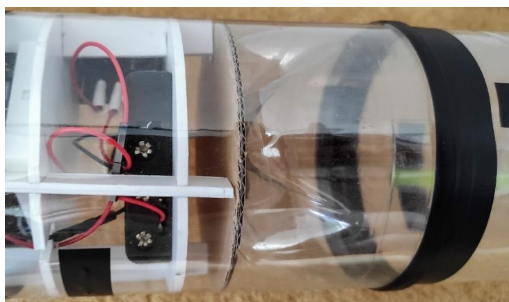
Obrázek č. 41 – Kartonový disk mezi osazením a trupem
