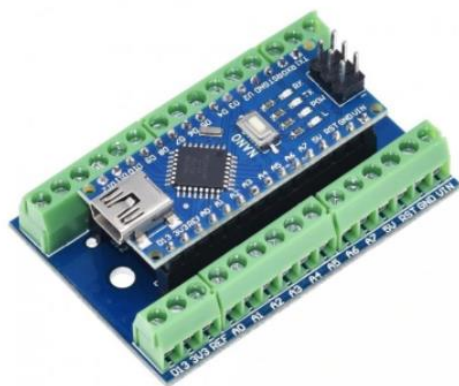
Obrázek č. 7 – Ukázka shieldu pro Arduino Nano
