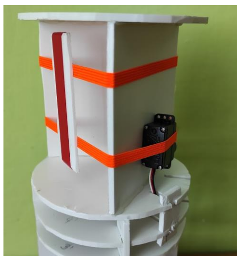
Obrázek č. 35 – Osazení pro padák a servomotor
