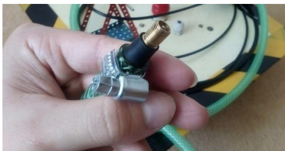
Obrázek č. 48 – Přívodní hadice pro tlakování rakety
