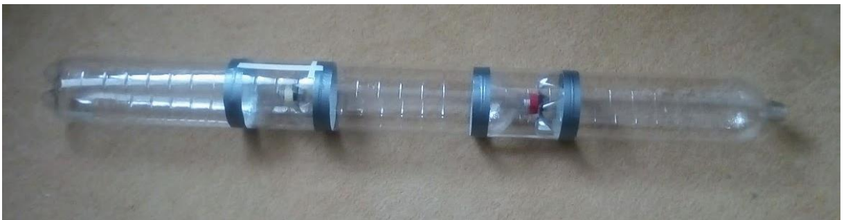
Obrázek č. 29 – Trup rakety TOM II s přilepenou kapotáží
