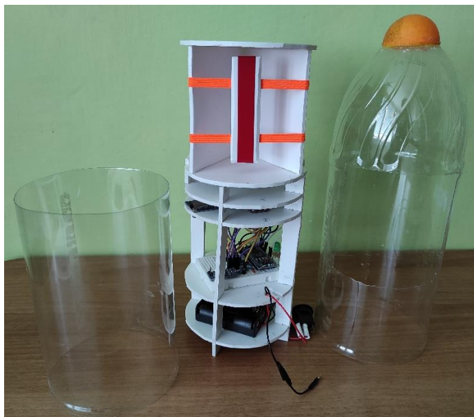
Obrázek č. 36 – Osazení pro měřící zařízení a padák s hlavičkou před sestavením
