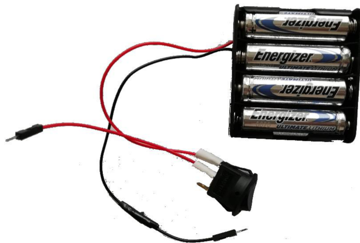
Obrázek č. 19 – 4 lithiové AA baterie v boxu (sériově) s přibudovaným vypínačem
