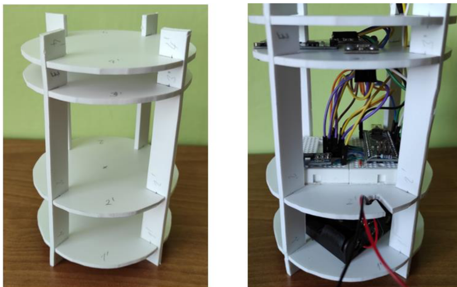
Obrázek č. 33 – Osazení pro měřící zařízení před a po vložení komponentů
