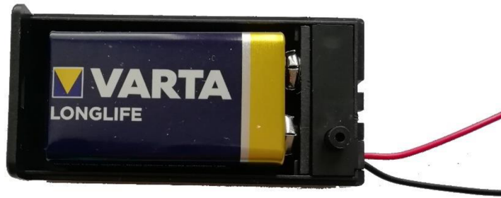
Obrázek č. 18 – 9 V alkalická baterie v boxu se zabudovaným vypínačem
