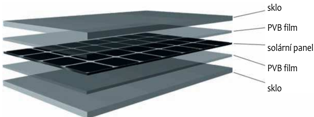
Obr. č. 11. Složení solárního článků při použití PVB (Isolar 2009).
