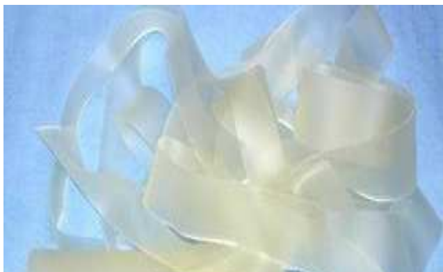
Obr. č. 13. Odpad při výrobě laminovaných skel
